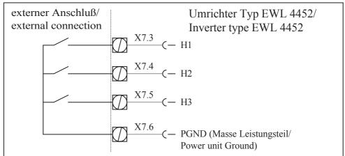
Achtung: Anschlüsse sind nicht potentialgetrennt vom Leistungsteil Note: Connections are not potentially isolated from the power unit
